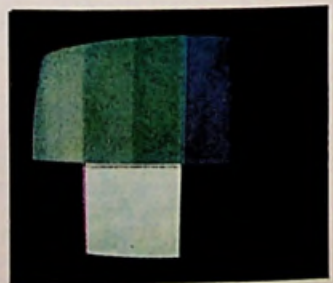
Afb. 101 - Zowel grijsinstelling (rechts) als de witinstelling (links) vertonen nog een kleur en zijn dus niet goed afgeregeld.
