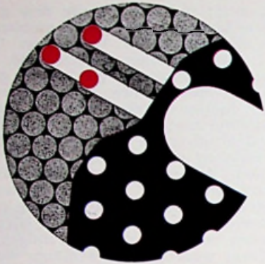
Fig. 91 - Dit gebeurt er als de straal niet is gefocusseerd, doch de kleurzuiverheid wél goed ingesteld.
